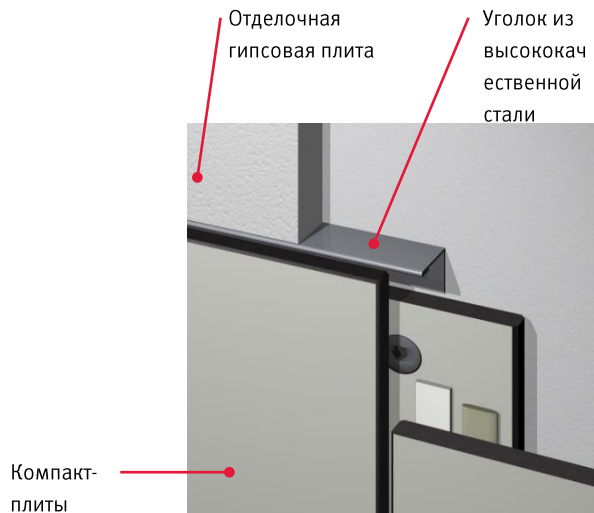
Рисунок 33 – частичная обшивка в половину высоты стены – Конструкция стены сухим способом (Стойки) Вариант крепления с помощью клея
