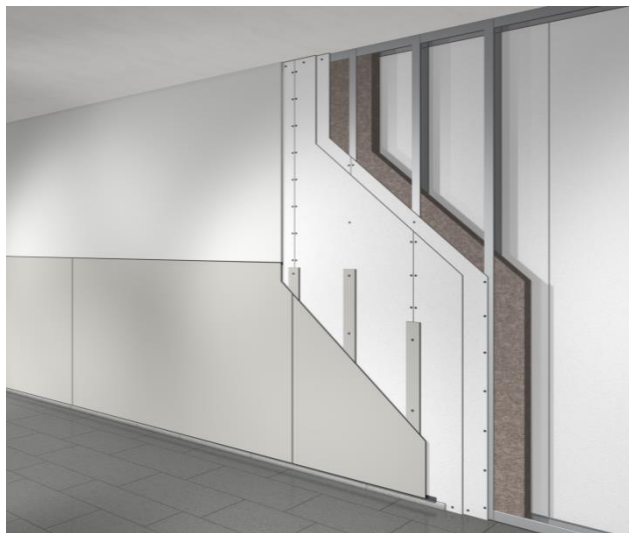
Рисунок 33 – частичная обшивка в половину высоты стены – Конструкция стены сухим способом (Стойки) Вариант крепления с помощью клея
